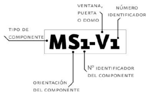
Fig. 3.12 Nomenclatura sugerida para los componentes de la envolvente.
