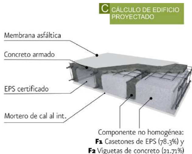
Fig. 6.19 Identificación de capas homogéneas y porciones no homogéneas para cálculo de valor K.
