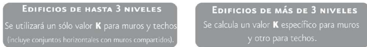
Fig. 3.13 Valor K de acuerdo al número de niveles del edificio de uso habitacional
